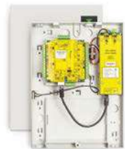
Net2 plus contrôleur 1 porte - Alim PoE, coffret ABS
