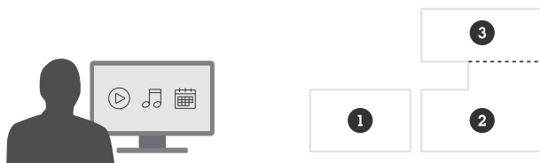
Figure 3.1b La répartition en zones permet de contrôler et d'adapter le contenu audio en fonction de l'audience. Il est facile de modifier les zones dans le logiciel selon les besoins. Dans cette installation, la deuxième zone a été divisée une nouvelle fois afin de créer une zone 3.
