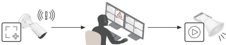
Figure 1.3b Solution surveillée : une caméra dotée d'outils d'analyse détecte les mouvements ou d'autres événements et envoie une notification à un opérateur. L'opérateur peut choisir de diffuser un message audio préenregistré ou de parler en direct via le haut-parleur.
