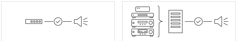
Figure 2.1a Gauche : Les haut-parleurs audio sur IP sont des systèmes audio complets. Droite : Les haut-parleurs traditionnels nécessitent du matériel supplémentaire.
