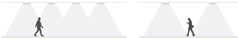
Figure 5.3a Gauche : dans une solution avancée, le son est homogène dans toute la zone. Droite : dans une solution de base, le son est moins homogène et des endroits présentant un volume sonore inférieur sont autorisés.
