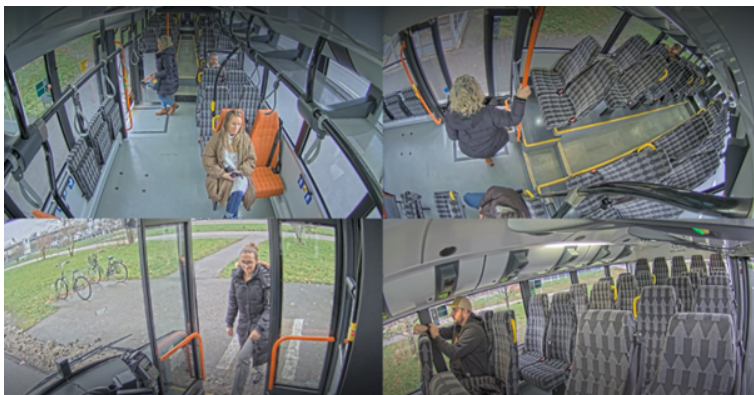
Visionnage en quadrivision en continu à partir d'un système de caméra modulaire à quatre canaux dans un bus.
