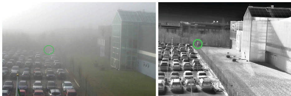
À gauche : image provenant d'une caméra conventionnelle dans une scène brumeuse. À droite : image provenant d'une caméra thermique dans la même scène brumeuse.
