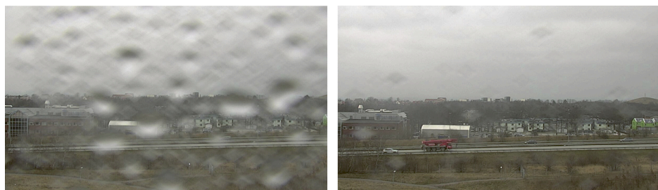
Deux instantanés de la même scène pluvieuse, avant de secouer (à gauche) et après avoir secoué (à droite) le dôme en utilisant la fonction de séchage rapide.
