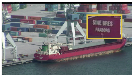
Vue large (gauche) et vue agrandie (droite) sur une caméra PTZ HDTV 1080p, rendant le texte sur le cargo lisible à une distance de 1,6 km (1 mile).
