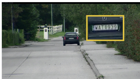
Vue large (gauche) et vue agrandie (droite) sur une caméra PTZ HDTV 1080p, permettant de lire la plaque d'immatriculation à une distance de 275 m (900 pieds).
