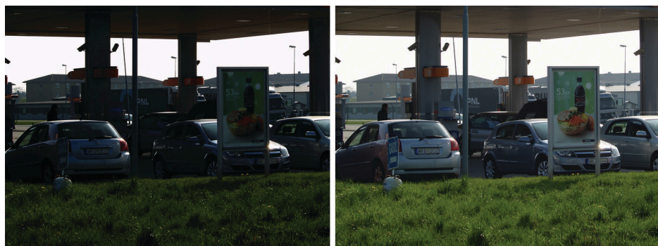
Fort contre-jour, sans compensation de contre-jour (à gauche). Avec la compensation de contre-jour, le premier plan est plus visible (à droite).
